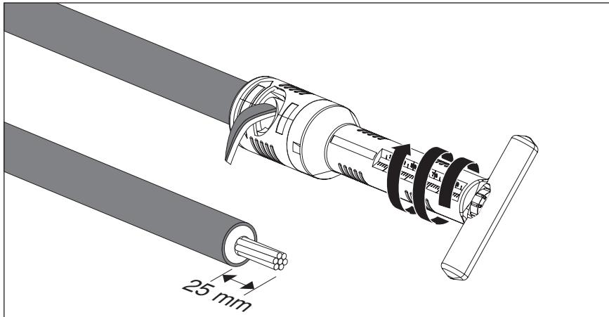
Рис. 27: Срезать изоляцию
