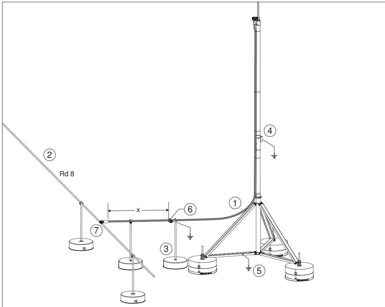
**Рис. 64:** Токоотвод isCon, подключенный к колышевому проводу, проложенному на определенной высоте от крыши
