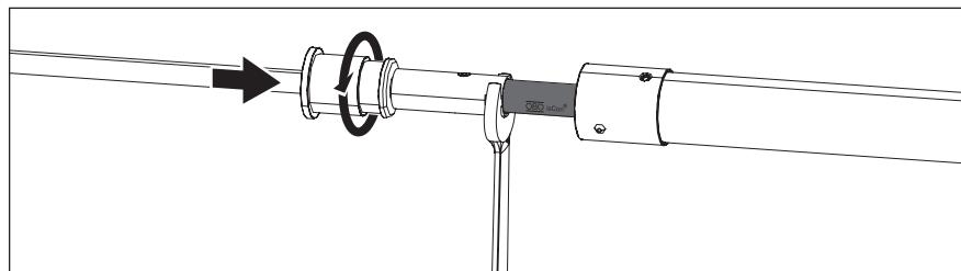
Рис. 34: Закрепить молниеприемный стержень на соединителе
