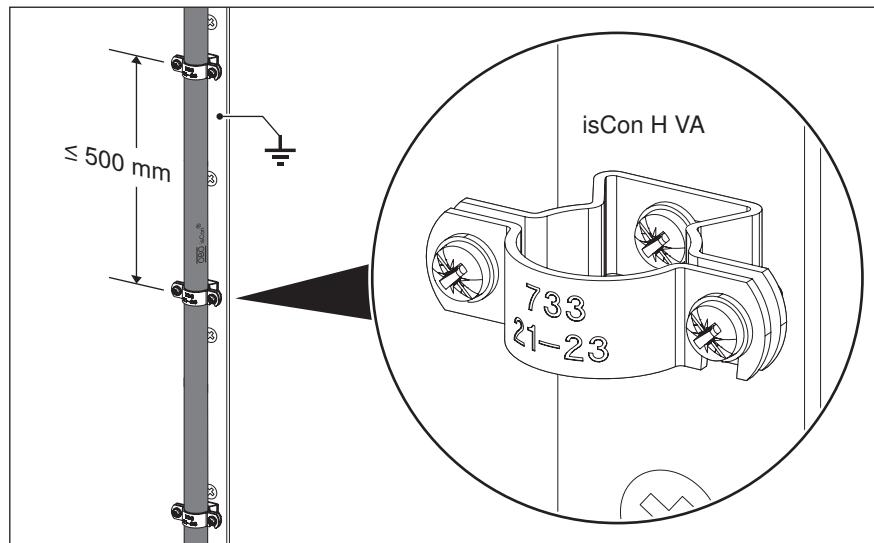
Рис. 62: Токоотвод isCon во взрывоопасной зоне, закрепленный на плоском проводнике с помощью держателя проволоки isCon H VA
