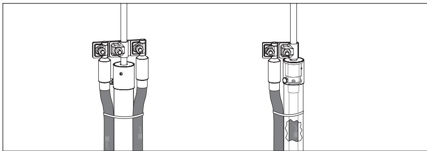
Рис. 14: Минимум 2 токоотвода isCon при классе молниезащиты I
