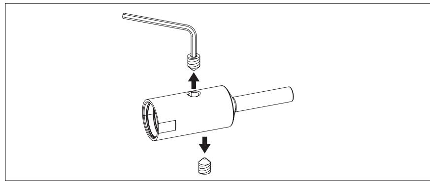
**Рис. 21:** Удалить стопорные винты
