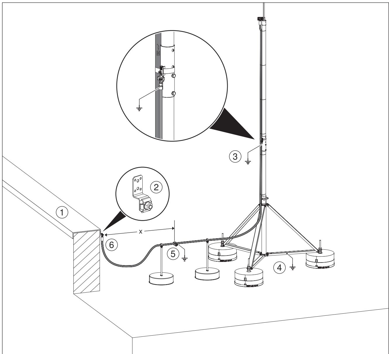
Рис. 65: Токоотвод isCon, соединенный с металлическим аттиком
