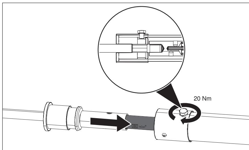
Рис. 35: Зафиксировать молниеприемный стержень в мачте
