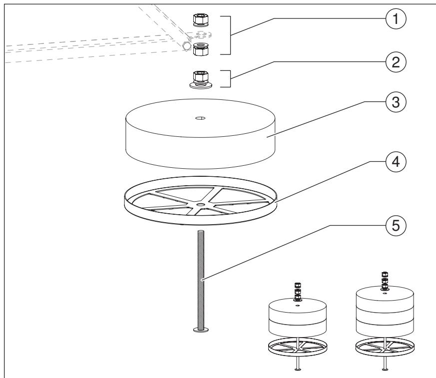
Рис. 44: Бетонное основание с крепежными элементами
