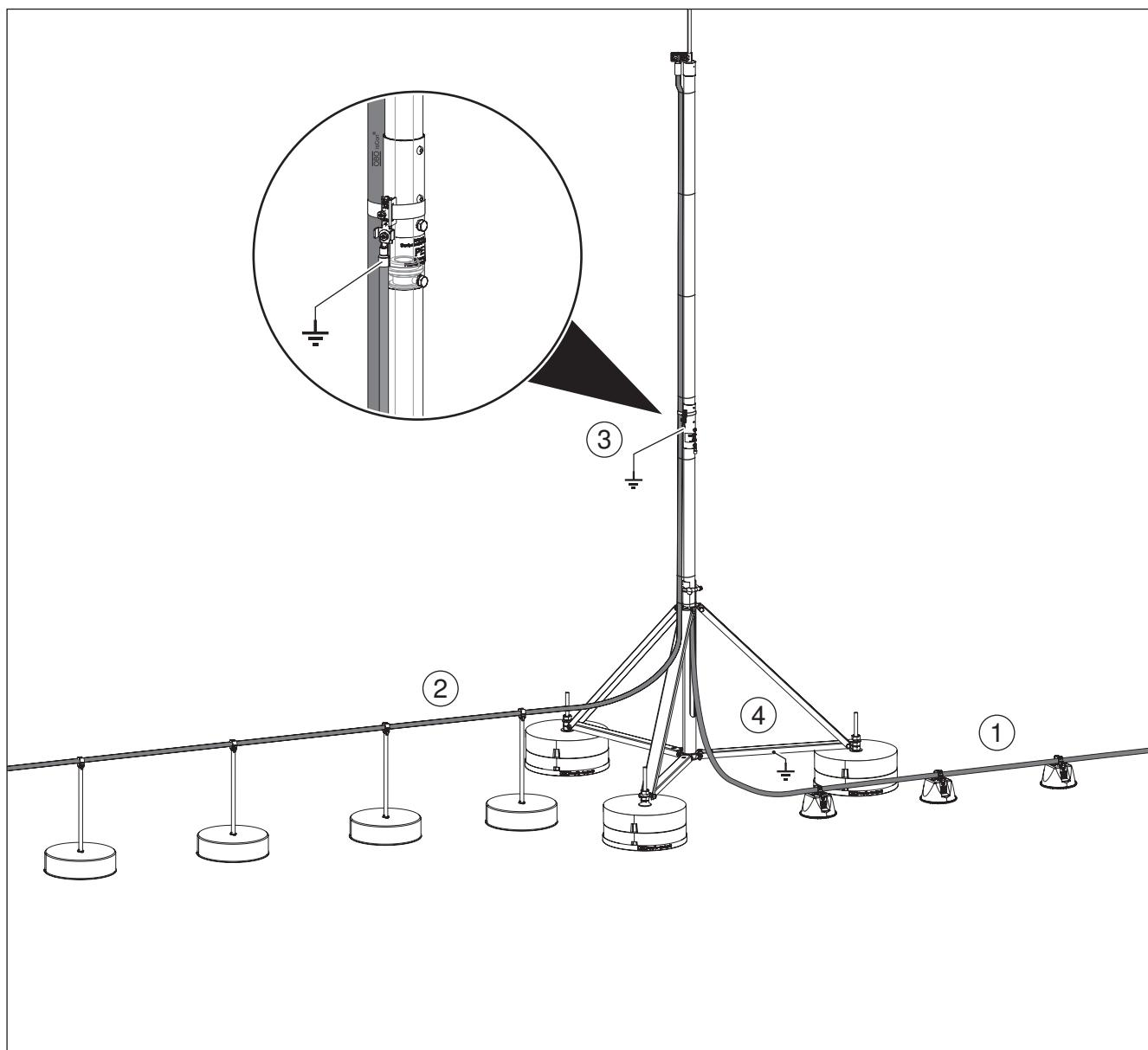
Рис. 66: Токоотвод isCon, проложенный внутри и снаружи мачты
