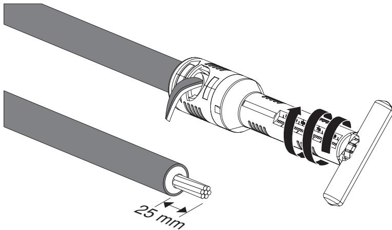
Рис. 20: Снять изоляцию
