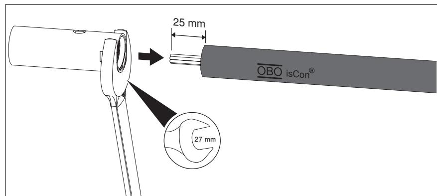
**Рис. 30:** Установить соединитель
