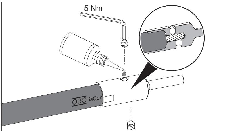
Рис. 24: Нанести фиксирующее покрытие и закрутить стопорные винты
