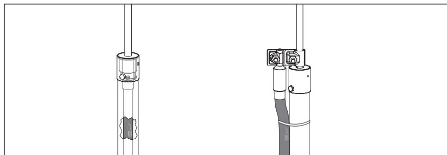
**Рис. 13:** Токоотвод isCon при классе молниезащиты II
