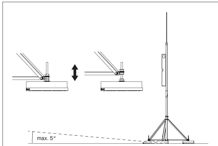
Рис. 48: Выровнять по наклону кровли
