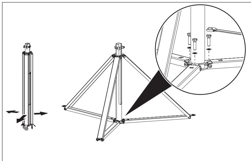
Рис. 46: Разложить и зафиксировать опору молниеприемной мачты
