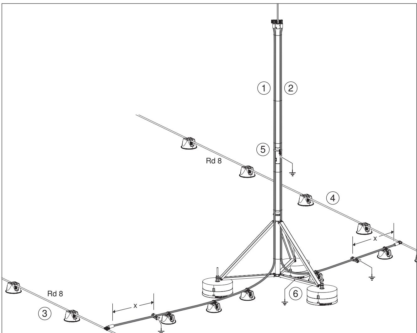
**Рис. 67:** Распределение тока по двум токоотводам isCon, например, при классе молниезащиты I
