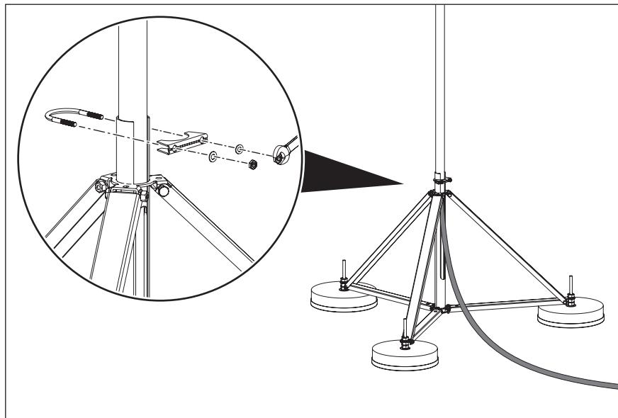
Рис. 50: Закрепить молниеприемную мачту в опоре
