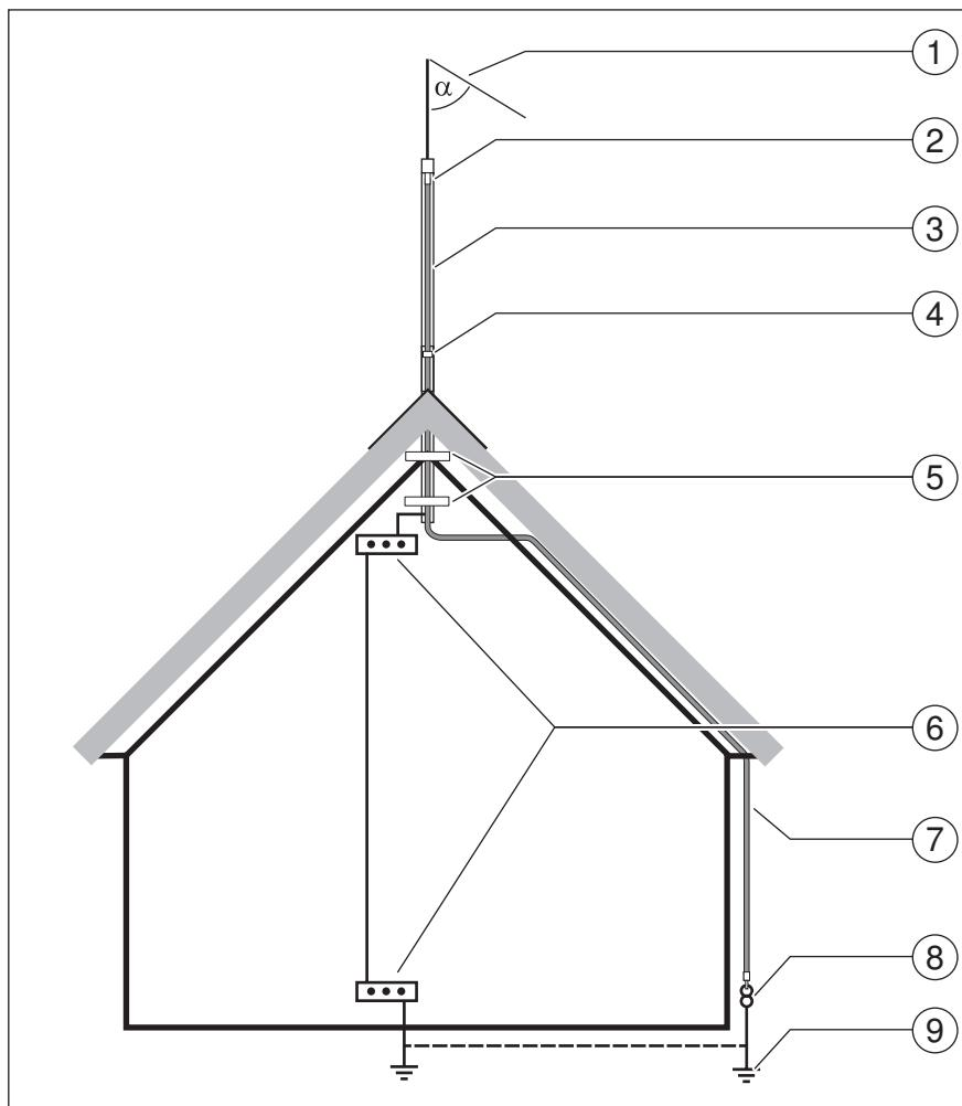
Рис. 16: Пример установки на мягкой кровле
