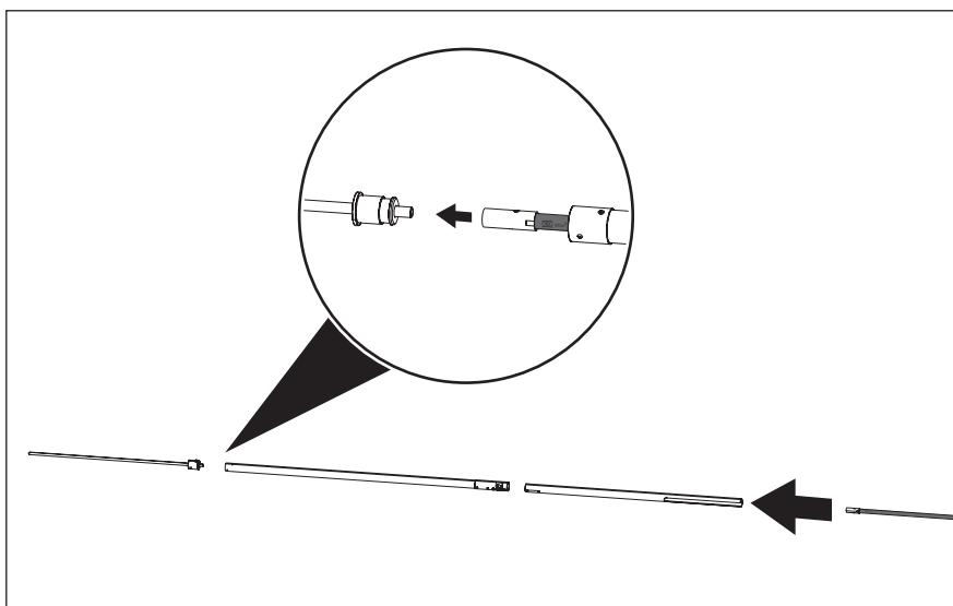
Рис. 33: Провести токоотвод isCon через молниеприемную мачту
