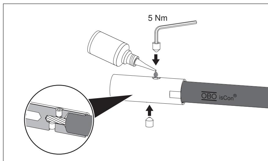
**Рис. 31:** Нанести фиксирующее покрытие и закрутить стопорные винты
