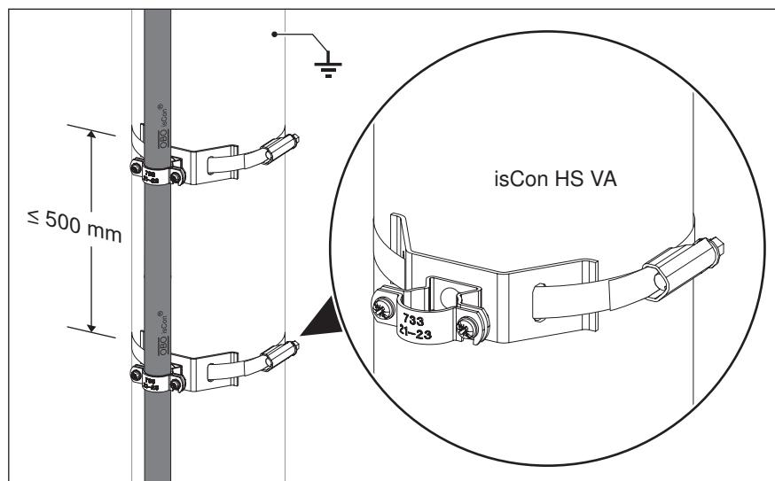
Рис. 63: Токоотвод isCon во взрывоопасной зоне, проложенный вдоль заземленной трубы
