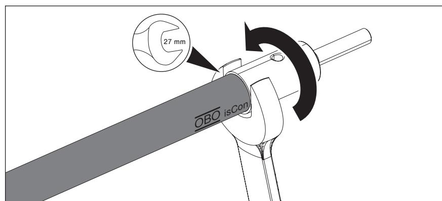
**Рис. 23:** Установить соединитель
