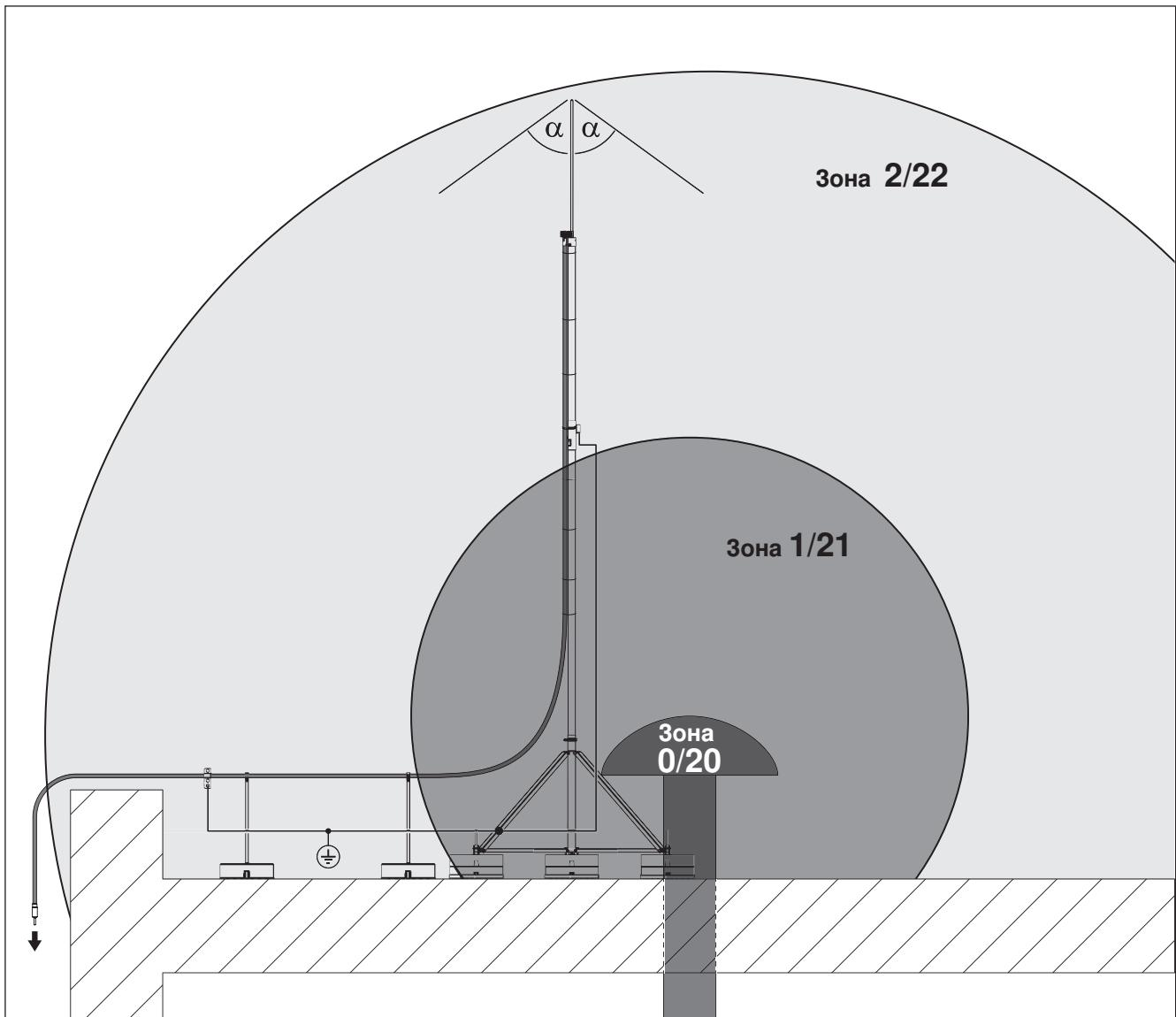
**Рис. 15:** Пример установки системы isCon во взрывоопасных зонах
